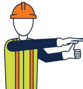
**Abaisser lentement la charge :** Étendre l'un des deux bras à l'horizontale à la hauteur des épaules. Garder le poing fermé et pointer le pouce vers le bas. Étendre le bras opposé qui se trouve le long du corps avec la paume vers le haut au niveau du haut du pouce pointé vers le bas. (Le signal ressemble à celui de « abaisser la charge ».)
