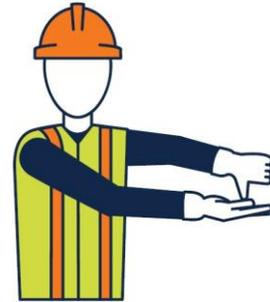
**Il reste cette distance :** Le signaleur commence en positionnant ses mains avec les paumes tournées vers l'intérieur pour refléter la distance restante pour le conducteur. Les mains se déplacent vers l'intérieur en même temps au fur et à mesure que la distance rétrécit jusqu'au signal d'arrêt.
