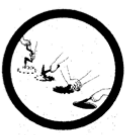
Utilisation d'outils à main pour retirer les panneaux muraux contenant de l'amiante
