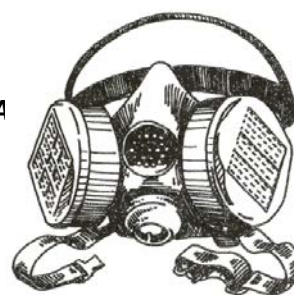
Appareil de protection respiratoire filtrant à demi-masque doté de filtres P100
