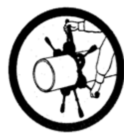
Coupage à la main de tuyaux contenant de l'amiante
